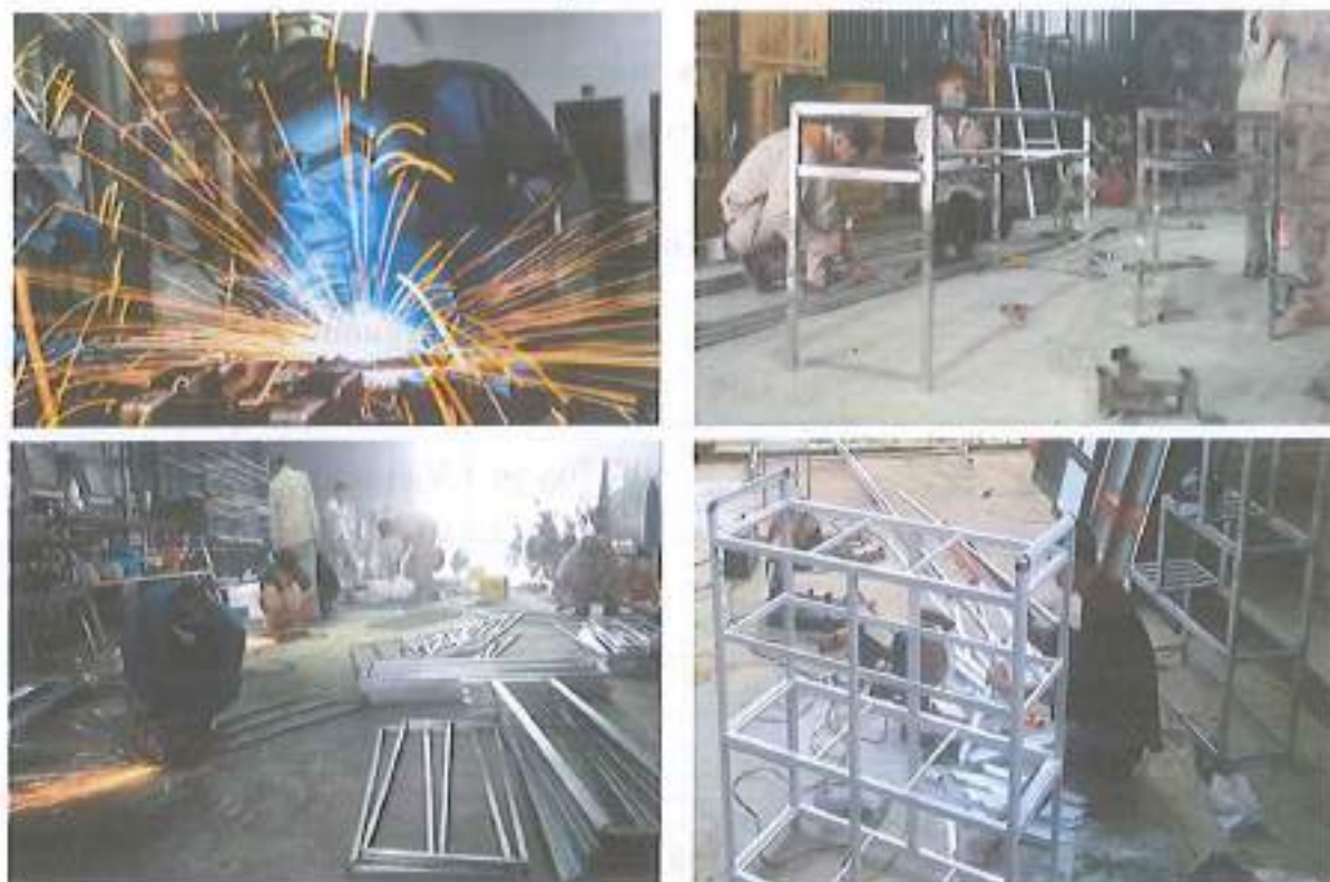
Hình 1.1. Hình ảnh minh họa công đoạn hàn các chi tiết
