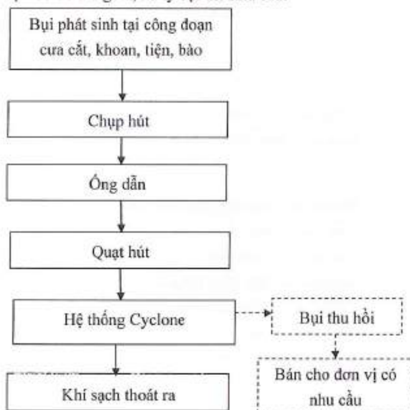
Hình 4.4. Sơ đồ công nghệ xử lý bụi thô
