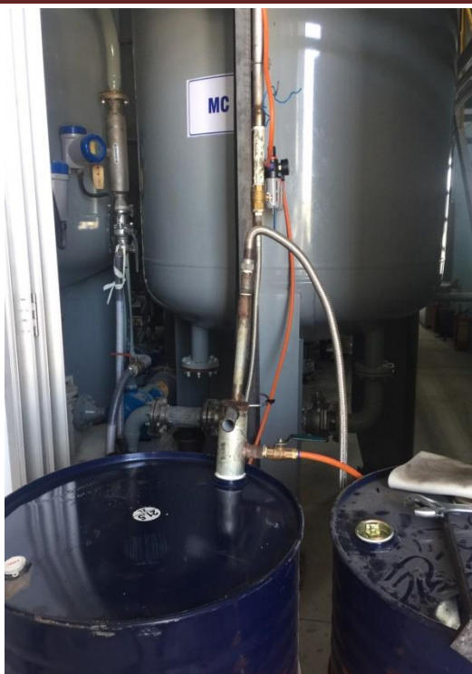
Hình 1.6. Bơm nguyên liệu vào bồn chứa trong phòng kiểm soát nhiệt độ
