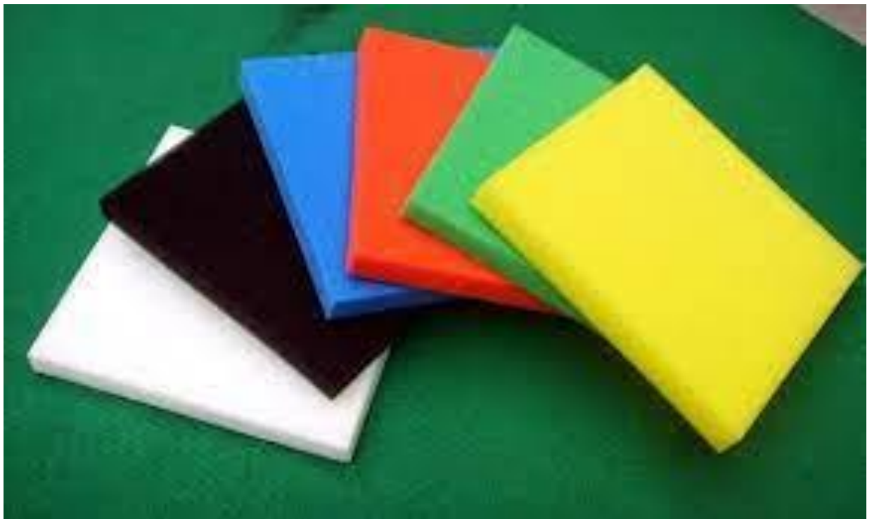
Hình 1.13. Bán thành phẩm gỏi từ tấm nhựa bọt Polyurethan: dài * rộng = 40-60cm*60-80cm.
