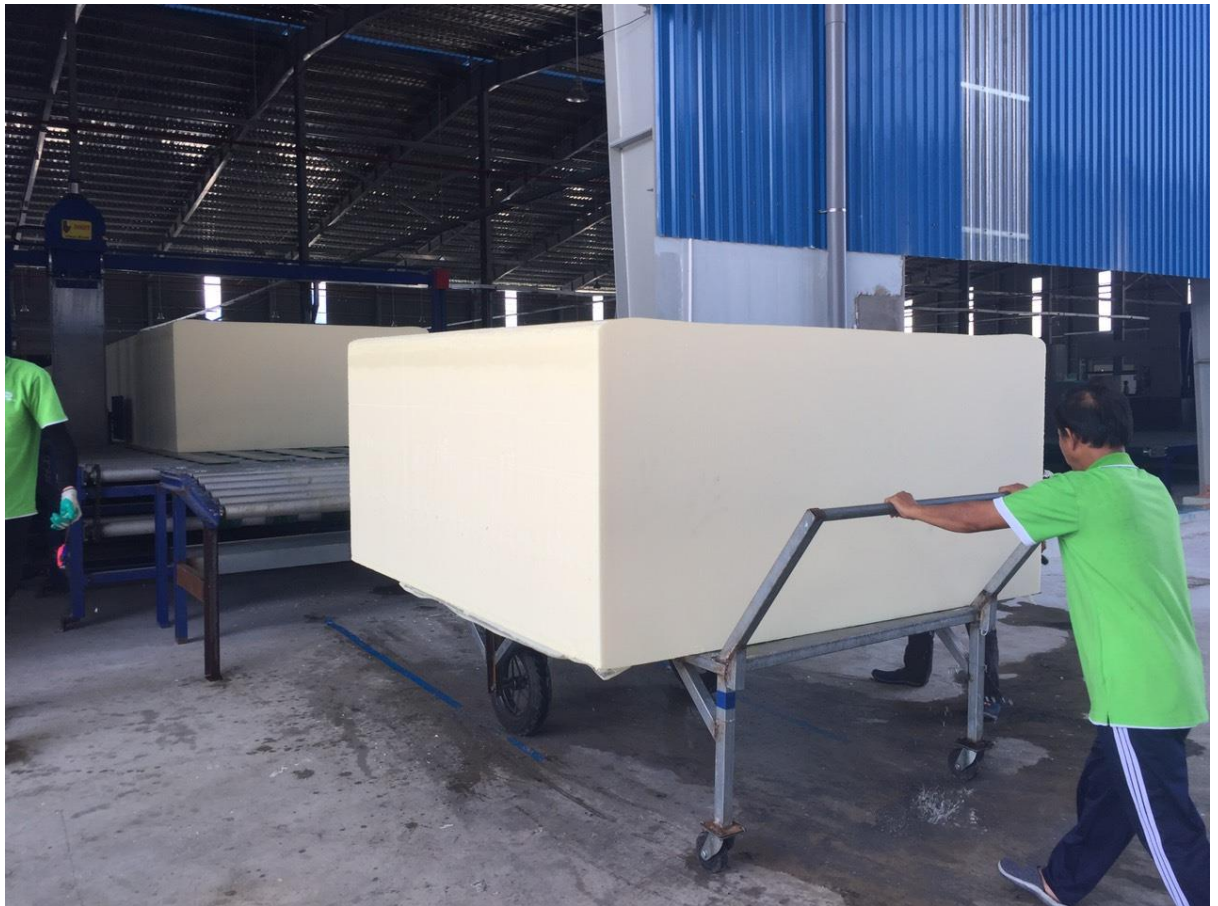
Hình 1.12. Tấm mút xốp (tấm nhựa bọt Polyurethane) sẽ cắt theo quy cách dài 5m-8m, độ dày 100cm).
