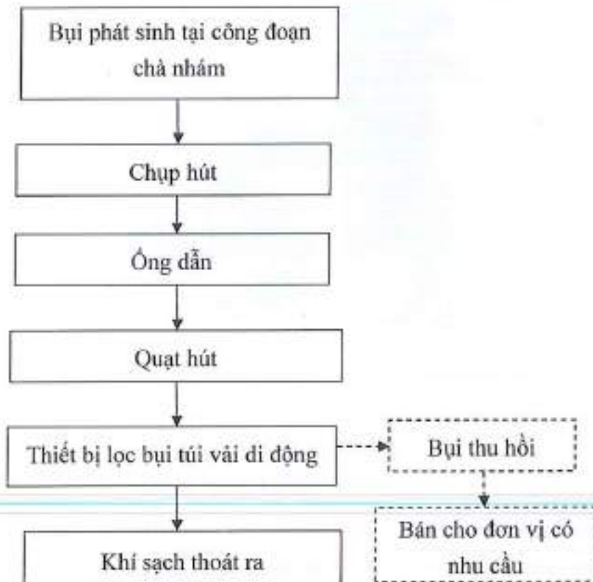
Hình 4.6. Sơ đồ công nghệ xử lý bụi mịn
