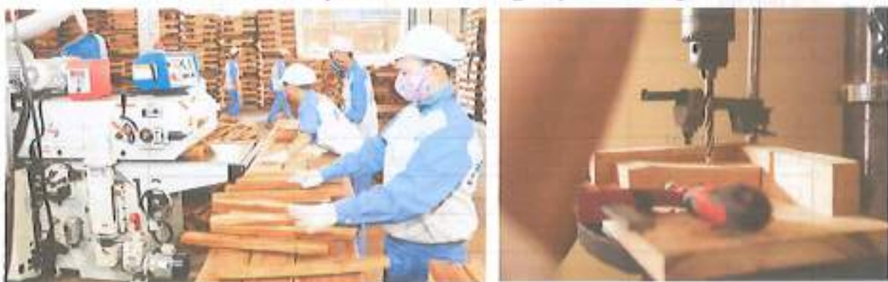
Hình 1. 3. Một số hình ảnh công đoạn bào, khoan
